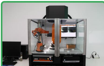
HD Prime台式X射线荧光光谱仪
